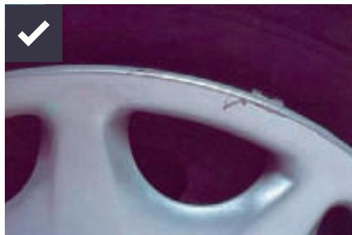
Minimalna sitna oštećenja duljine manje od 80mm ili blaga oštećenja na poklopcu kotača (ratkapi)/aluminijskim naplascima po kotaču
