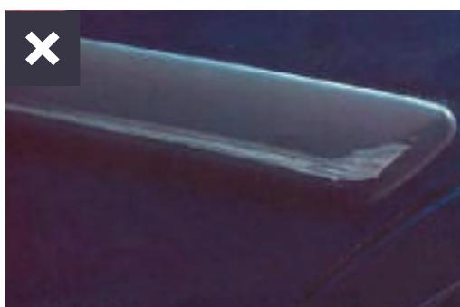
Oštećenja do karoserije i više od 1 oštećenja dužeg od 100 mm
