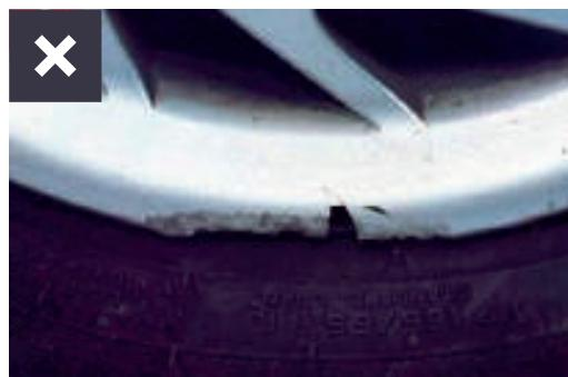
Oštećenja ili pukotine na poklopцу kotača
