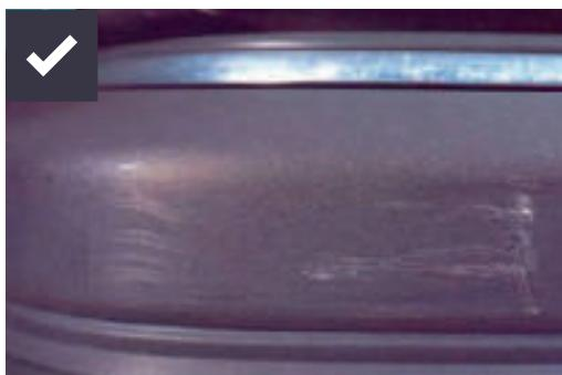
Blaga oštećenja odbojnika pod uvjetom da se može popraviti bez zamjene
