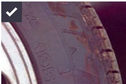
Abrazije na bočnoj stijenci mogu se očistiti običnim održavanjem
